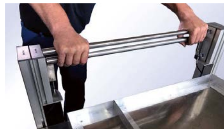
Totmannbremse (Griffstange: ziehend)
